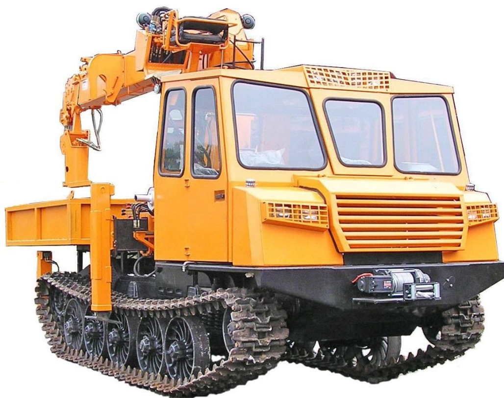
Рис. 2. Буровая машина МСН-10-BUER LS с трехместной кабиной оператора
